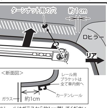
※テールゲートウインドウへのレールの貼り付けは、窓枠に對してセンターアルミレールの貼り付け位置
