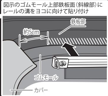
※3列目ウインドウへのレールの貼り付けは、窓枠に對してセンターアルミレールの貼り付け位置
