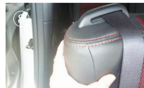
⑧ カバーをシート全体にかぶせます。始めにシート肩口に生地がしっかりと馴染むように、シートに密着させていきます。
