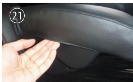
ヘラなどを使用して部材を入れ込みます。入り込む隙間は本当に限られた位置にしかありません。カバーの装着や生地の引っ張り具合により、部材と入れ込む隙間の位置にずれが生じます。その場合はカバーの装着を調整して下さい。
