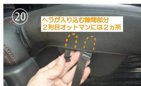
オットマン側面の生地裏に、図のような小さい部材が付いています。こちらはオットマンのチに図のようにヘラが入り込む隙間が一部分のみがあるので、その隙間に部材を入れ込みます。
