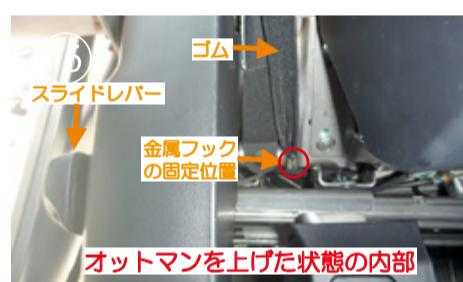
もう1本のゴムも同様に金属フックを取り付けて、オットマン付け根の内側にゴムを真っ直ぐに引っ張り、オットマン内部の金属部分に引っ掛けで固定します。図では固定位置が見えづらいですが、オットマンの動作に干渉しない位置に金属フックを固定して下さい。
