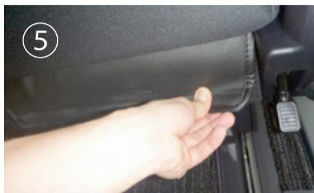
引き出した生地を直接シートにマジックテープで貼り付けて固定します。
