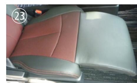
カバーのラインを整えて、2列目・3列目運転席側座面の完成です。助手席側も同様に取り付けます。
