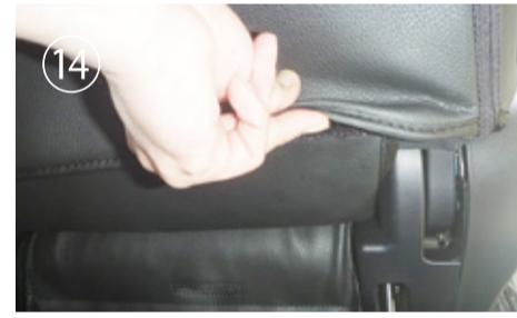
⑭ 先程(★マークの図⑩で)引き出した生地とカバーの背面下を、マジックテープで固定します。
