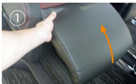
オットマンを一番上まで上げた状態でカバーの装着を行います。オットマン部分からカバーをかぶせ矢印の方向へ先端まで生地が張るようにしっかりとかぶせます。
