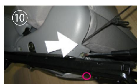
プラスチックカバー後部のネジをプラスドライバーで外し(○印)、その中に紐を通して下さい。
