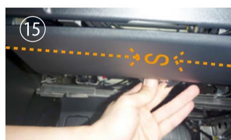
オットマンを跳ね上げた裏側をシートの前側から見た図です。図には写っていませんが、入れ込んだゴムをオットマンの内側から引き出してゴム同士を矢印方向へ引っ張り、金属フックでつなぎ留めます。
