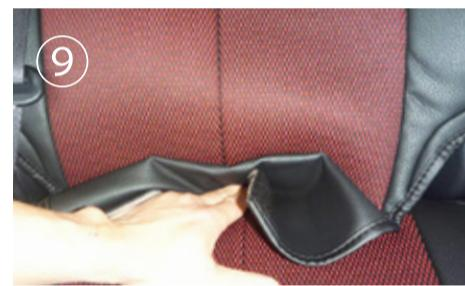
⑨ カバーのラインに合わせてカバーをかぶせて、背もたれと座面の隙間に生地を入れ込みます。
