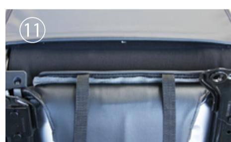
シートカバーを表面より差し込んだ後、ベルトを裏面に回して下さい。
