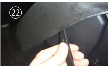
部材はヘラなどを使用してしっかりと入れ込みます。これによりカバー側面の生地の浮きなどが抑えられます。
