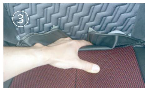
背もたれと座面の隙間に生地を入れ込みます。
