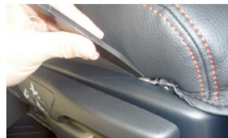
カバー側面の生地をシートとプラスチック部に入れ込みます。カバーのラインがシートからはずれないように注意して、内側外側共に入れ込みます。
