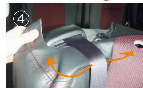
④ 背面のファスナーを開けた状態で、肩口のシートベルトをかわして、シートを包み込むようにカバーをかぶせます。
