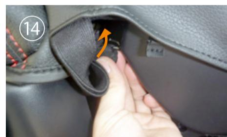
図の隙間から内側外側のゴムを、共に入れ込みます。
