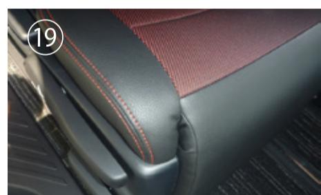
生地を全て入れ込むと図のように収まります。先端に生地が余るようだとカバーがシートのラインからずれている可能性があります。その場合はカバーの装着位置を再度調整して下さい。
