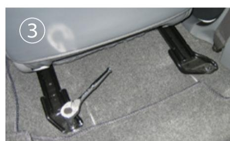
14mmBOXレンチを使用し、シートを外して下さい。(ボルト4箇所)
