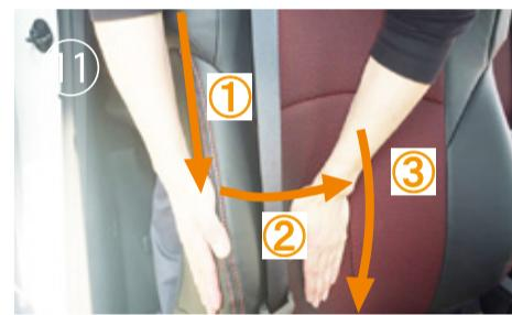
⑪ カバー側面の生地を①→②→③の順番にシート中央へ集めるようにして馴染ませていきます。生地がシートに馴染むまで繰り返し行って下さい。
