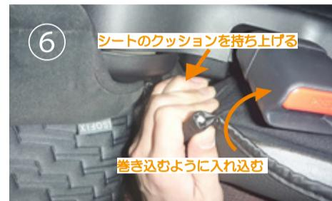
シートの付け根部分。シートのクッションを少し持ち上げるようにして隙間を作ります。その隙間にカバーの端に付いている固定部材をシートを巻き込むようにして入れ込み固定します。内側外側共に行います。
