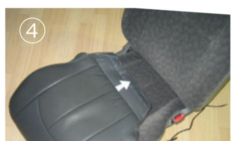
シート面部前方より矢印の方向へ被せて下さい。
