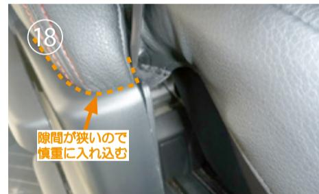
生地を入れ込んでいきます。図の点線部分にシートのラインに合わせて生地を入れ込みます。先程開いたプラスチック部は生地を挟み込み固定します。生地を入れ込み過ぎるとツメがはまらなくなるのでご注意下さい。
