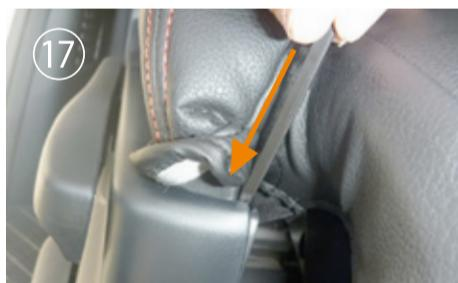
オットマン付け根部分のプラスチック部に生地を入れ込みます。生地を入れ込む前に図のプラスチック部の内側にヘラなどを差し込むとツメが外れてプラスチック部が開きます。こうすることで生地が入れ込みやすくなります。
