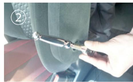
② アームレストを固定しているボルトを、ソケットレンチなどを使用して外します。ソケットは14mmを使用します。
