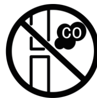
煙突の外れ 危険
