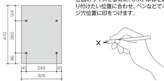
3 印をつけた位置にコンクリートプラグのサイズに合う大きさの穴をあけ、接着剤を注入します。
