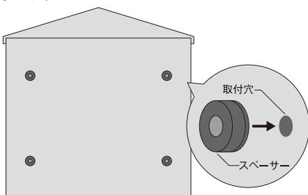
2 左図のサイズを参考に、ポスト本体を取り付けたい位置に合わせ、ペンなどでネジ穴位置に印をつけます。
