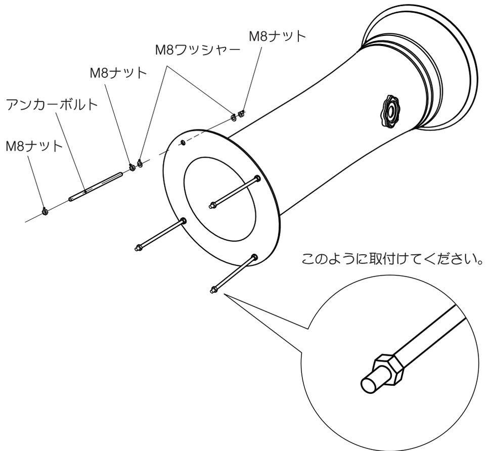
【2】現場寸法に応じて給水管を延長します。
