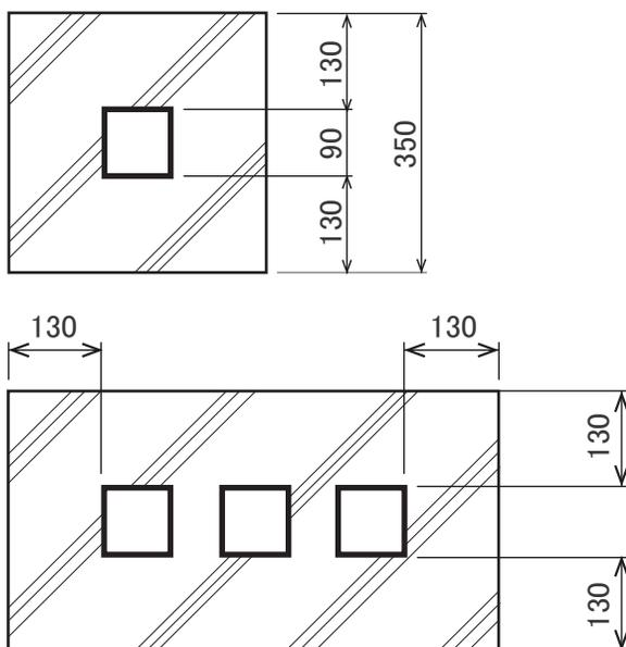
※複数のNティンバーを隣接して施工する場合は根巻き代を130mm確保してください。
