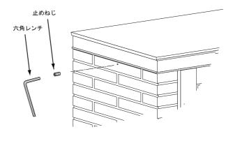
DSB-IM7 2005.03A (1)本体側面(左右)上部に転倒防止金具を取り付けます。
