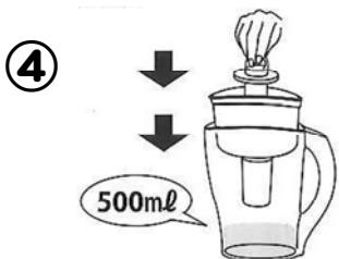
浄水タンクに約500mlの高さまで水道水を入れてください。浄水タンクに原水タンクをセットします。カートリッジを原水タンクに止まるところまで差し込みます。そのままカートリッジを水道水に約20分間浸します。
