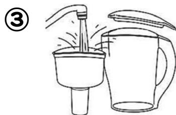
浄水タンク・原水タンクを水道水でよく洗浄します。(カートリッジは中性洗剤等で洗わないでください。)
