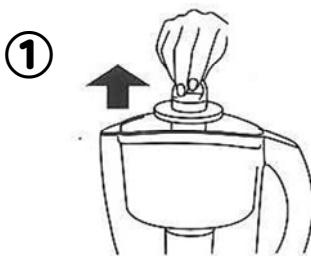
ご使用済みのカートリッジの上部のリングをひっぱり、原水タンクから外します。
