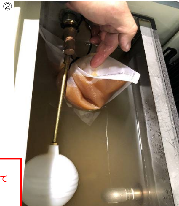
【金型温調機使用例】 冷却水 補給水部に軟水バッグフィルターハ ウジングを取り付けています。
