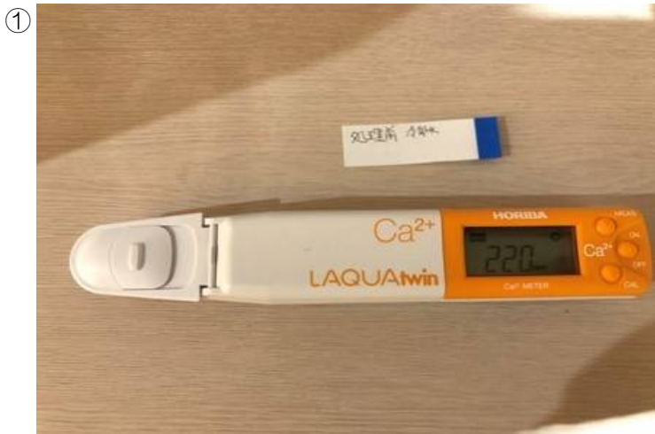
① 処理前 2/11 処理前 工場内冷却水 チラー 水槽より採取
