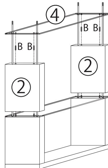
2 ①で組み立てた【天板】の【支柱ボルト】と【ダボ】に【②支柱板】のボルト穴・ダボ穴を合わせて挿し込みます。【②支柱板】のダボ穴に【B ダボ】を挿し込んだら【④ガラス板】のボルト穴・ダボ穴に合わせて挿し込んで下さい。
