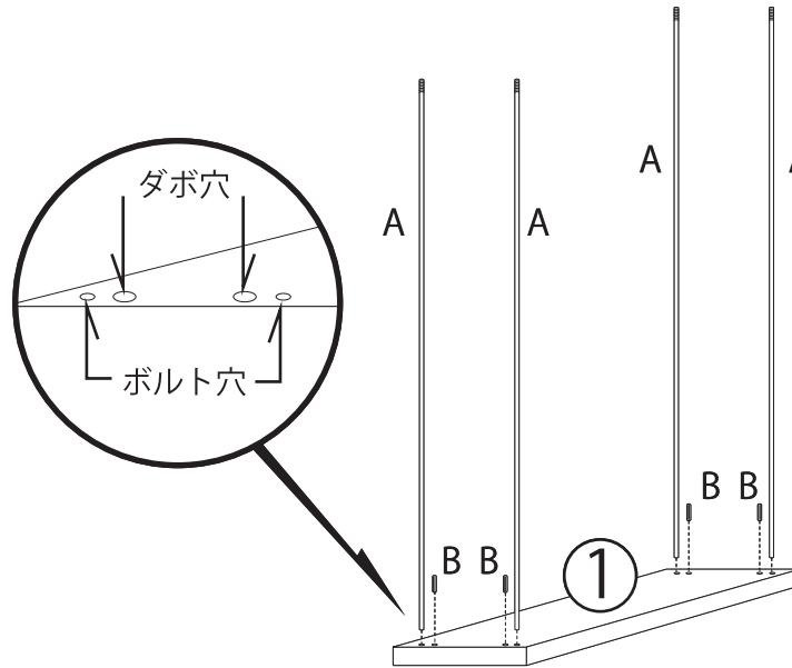
3 ②で組立てた【ガラス板】の【支柱ボルト】と【ダボ】に【②支柱板】のボルト穴・ダボ穴を合わせて挿し込みます。【②支柱板】のダボ穴に【B ダボ】を挿し込んだら【④ガラス板】のボルト穴・ダボ穴に合わせて挿し込んで下さい。
