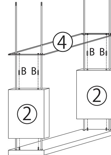
4 【ガラス板】の【支柱ボルト】と【ダボ】に【③支柱底板】のボルト穴・ダボ穴を合わせて挿し込みます。【③支柱底板】のボルト穴に【C ワッシャー】と【D ナット】を重ねて挿し込んだら【E 筒形レンチ】で締めて下さい。
