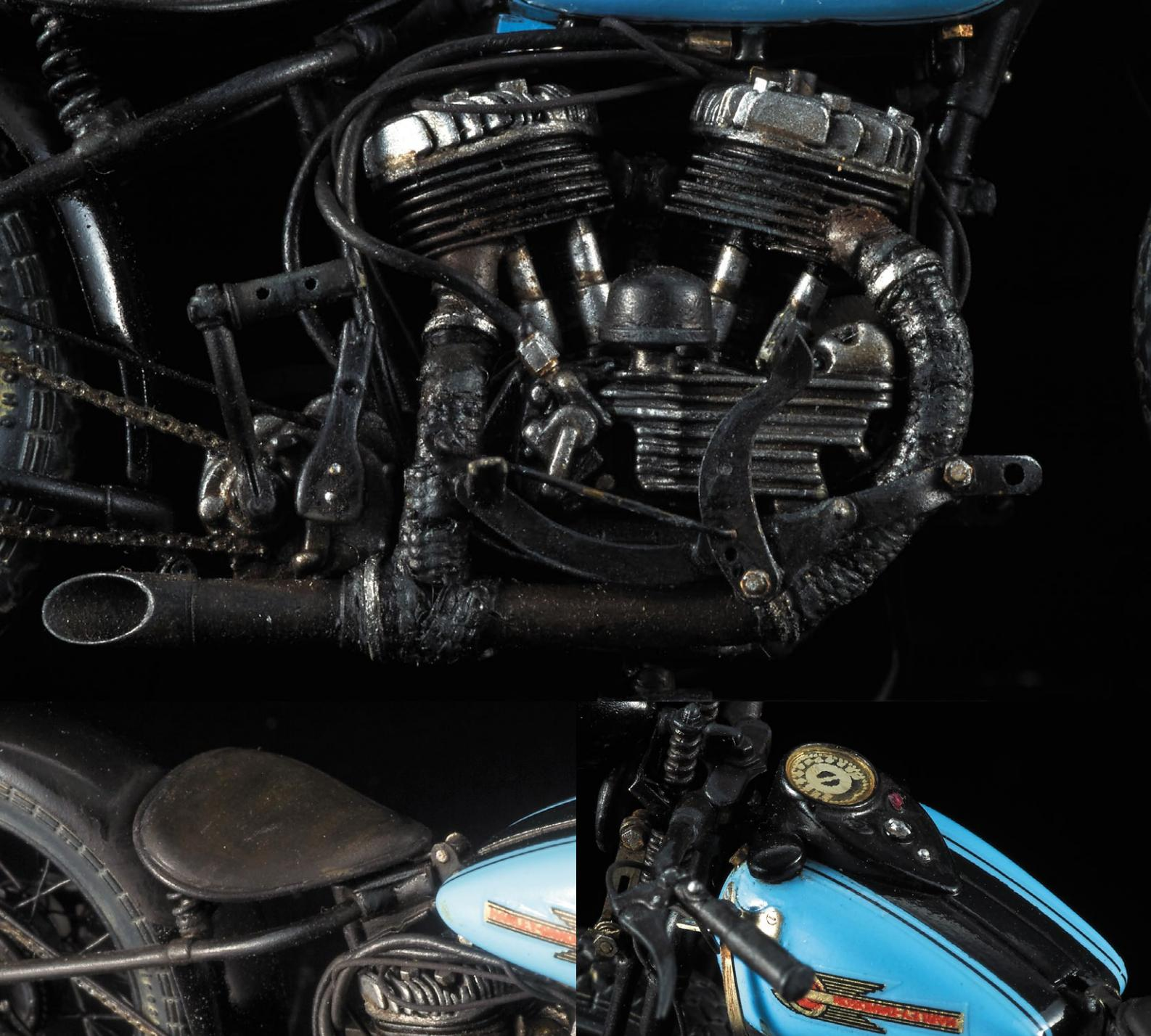
1937~'51、'52年の15、16年間製造されたWL MODEL。この作品は、1937年から'39年までのいわゆる"30s"と呼ばれる年式のWLボバー。フロントフェンダーを取り外し、リアフェンダーはかなりショットアップされ、タイヤをすれすれにマウントされた仕上がりはハードテールをより強調したレーシーな印象をあたえている。フットボードの代わりにペグ式のステップや、キックペダル、軽量穴明けのドリルドなどで軽量化をはかり、また、Fサスのライドコントロールやマフラー、エンジンをカットして、放熱バンテージを巻き付けたレーススタイルのマフラーなどもヨーロッパーレーサー感を上げて、ヘッドライトを外せば即レースに参戦できる仕上がりだ。30sならではの前後18インチのタイヤサイズもGOODな選択！
