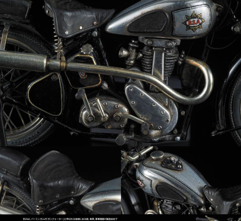
BSAは、バーミンガムの「ガンクォーター」と呼ばれる地域にある銃、車両、軍事機器の製造会社であり、1910年にBSAはバイクの生産を開始し、50年代のビーク時には世界最大のバイク生産社だった。優秀なエンジニアであるヴァル・ペイジは、1939年にBSA M23シルバースターという、4速ギアボックスを備えた500cc OHVシングルシリンダーエンジンのスポーツマシンを設計した。このマシンにいくつかの革新的で最新の機能が含まれていた。単一のバックボーンを備えたスチールチューブラーフレームを採用し、クランクケースのサンブは廃止、左側からチェーンで駆動された。 Silver Starエンジンは、BSAワークスによりチューニングされている。本様型では兄弟車であるM23 Empirestarに見られるアップマフラーを装着した仕様としている。
