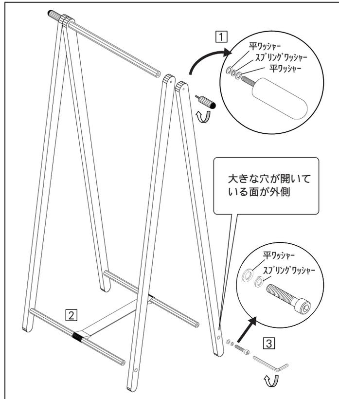
① まず、脚の下の方に大きな穴が開いている面が外側に向くように 2 本重ねます。脚の上部に太い横棒を合わせ、手掛けでしっかりと締めて固定します。左右それぞれ同じように固定してください。
