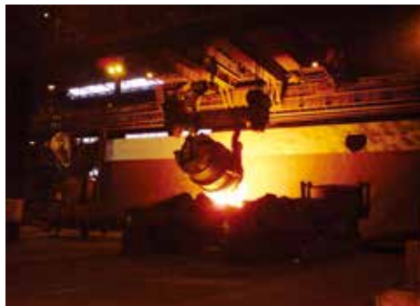
このレードルの耐火生物質は劣化の特長を示しており、劣化が進むと修理が必要となる。耐火性物質の検査ができるのは実質的に赤外線カメラだけである。
