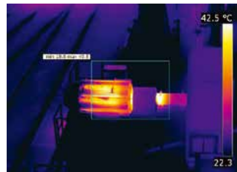
この電気モーターには過熱が生じており、検査し、不具合が生じる前に修理する必要がある。
