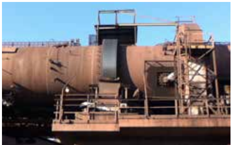
これらは、毎週行なわれている6つの直接還元製鉄設備 (DRI) の検査画像の一部です。これらの画像を分析することで、耐火材が劣化したり、内部に製品が堆積したりしていないか調べています。
