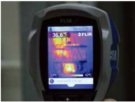
赤外線サーモグラフィFLIR i7はさまざまな機器の点検に使用される。
