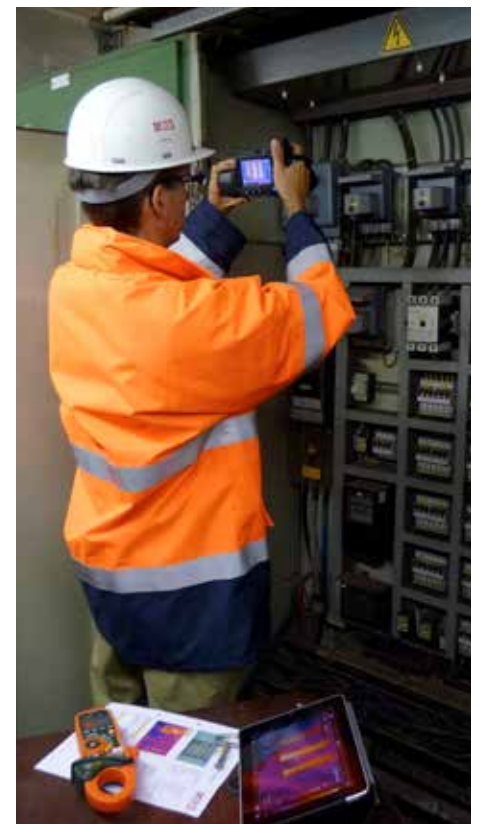
FLIR T440のレンズを45°の広角レンズに交換し、狭いスペースで赤外線画像を撮影するWeight氏。
