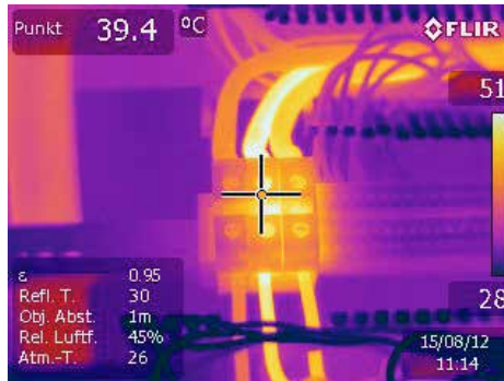
問題のあるケーブルや端子が明確に分かります。システムのオペレーターが、原因を調べる必要があります。
