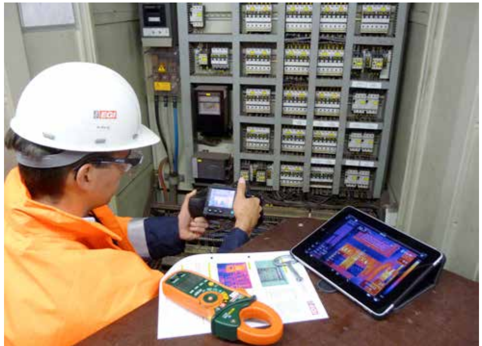
赤外線検査を行なうWeigt氏。Extech社のクランプメーターからのデータがBluetooth経由で赤外線サーモグラフィに転送されています。FLIR T440は、赤外線画像をワイヤレスLAN経由でタブレットPCに転送しています。
