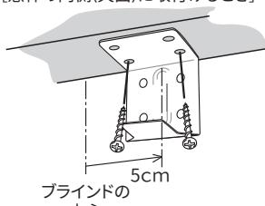
[窓枠の外側(正面)に取付けるとき]
