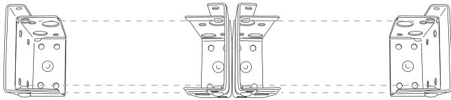
ブラインドを2本以上連結する際には、取付け金具を上図のように背中合わせにし高さを揃えて、固定してください。
