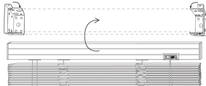
ブラインド本体をブラケットにはめ込み、左右のサイドブラケットのふたをカチッと閉じてください。幅の大きい製品の場合は必ず2人で作業してください。
