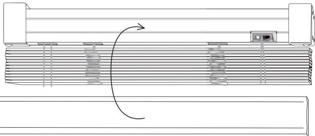
バランスに取付けた金具をブラインド本体に引掛けてバランスを固定します。
