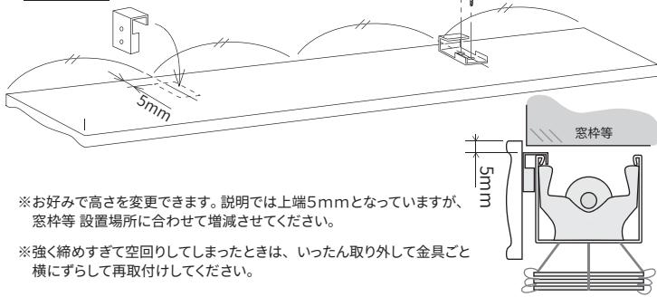
※お好みで高さを変更できます。説明では上端5mmとなっていますが、窓枠等設置場所に合わせて増減させてください。
