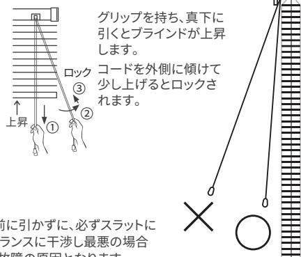
※昇降操作をする際はコードを手前に引かずに、必ずスラットに近い位置で操作してください。バランスに干渉し最悪の場合バランスが落下し、ケガや製品の故障の原因となります。
