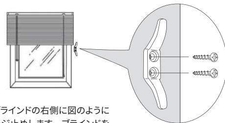
ブラインドの右側に図のようにネジ止めします。ブラインドを上げた時に昇降コードを巻きつけてご使用ください。
